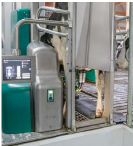
Lypsyrobotti takaa. Huoltosyvennys helpottaa pääsyä robotille.
