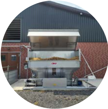
Olkisäiliö sähköisesti avautuvalla kannella ja repijäterillä.
