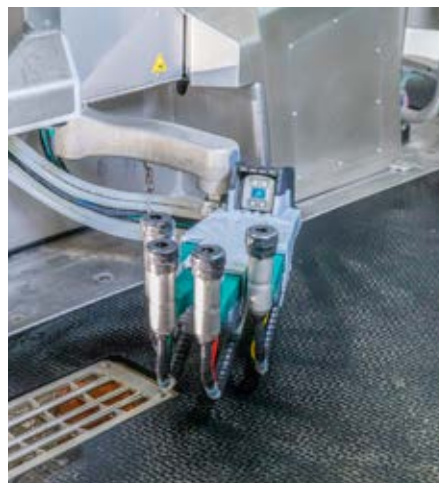
Koko lypsyprosessi suoritetaan esihieronnasta vedinkastoon yhdellä kiinnityksellä, vedinkupin sisällä.
